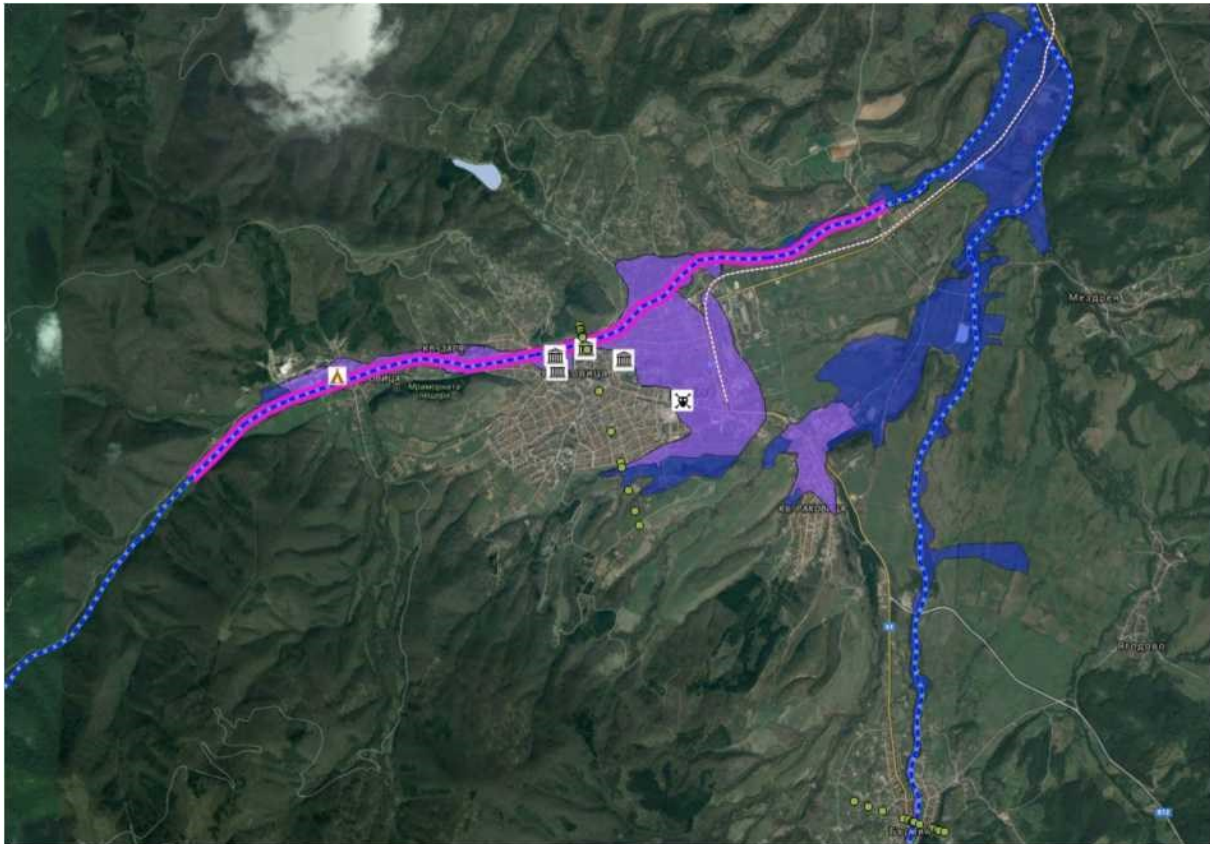
Фигура № 2.1.3.1-9. Моделирана залята площ (в лилаво – залята урбанизирана площ, в синьо – залята не урбанизирана площ) при гр. Берковица, съгласно ПУРН (Източник: ПУРН за Дунавски район)
